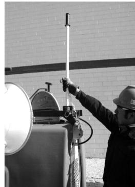
Coloque una palanca de mástil en la posición que se indica en la figura; asegure la palanca con el seguro, en adelante ésta será la “palanca #1”.
