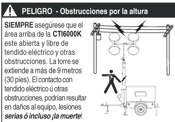
El sistema de iluminación de la torre de iluminación **CTI6000K**, consiste de 4 lámparas de "Metal Halide" de 1,000 watts. Cada lámpara tiene una potencia de salida de 110,000 lúmenes produciendo un total de 440,000 lúmenes para las cuatro lámparas de alta intensidad. La cobertura de la iluminación típica es de entre 2 a 3 hectáreas.
